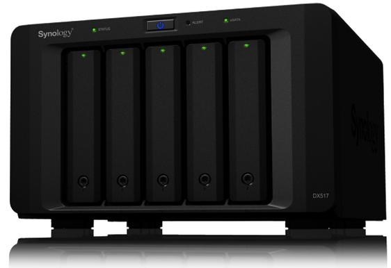
Le Synology DX517 représente une solution simple d'extension de la capacité de stockage pour votre DiskStation grâce à sa conception plug-n-use intuitive. Le DX517 vous permet de passer instantanément à 5 disques durs supplémentaires, ce qui vous permet d'étendre en ligne votre volume RAID ou de déployer les disques en tant que destination de sauvegarde locale dédiée pour votre DiskStation. Le Synology DX517 est couvert par une garantie limitée de Synology de 3 ans.
