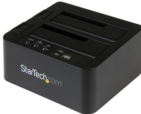
Dupliquez rapidement des disques durs, à des vitesses pouvant atteindre 28 Go par minute pour les SSD, sans devoir connecter votre ordinateur. Ce duplicateur offre un clonage de disques autonome, qui facilite la sauvegarde de vos données et reproduit des images exactes de vos disques. Vous pouvez également connecter la station d'accueil à votre ordinateur par l'USB 3.1 (10 Gb/s) pour connecter et échanger vos disques dans le cadre d'une solution de stockage évolutive.
