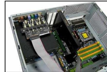
Der Zusatzsteckplatz oberhalb des Netzteils kann zur Installation bspw. einer CLEARCMOS- oder ASUS Xonar HDAV1.3 Deluxe-Tochterkarte genutzt werden; dadurch werden für andere Zwecke erforderliche Steckplätze am Motherboard nicht belegt.
