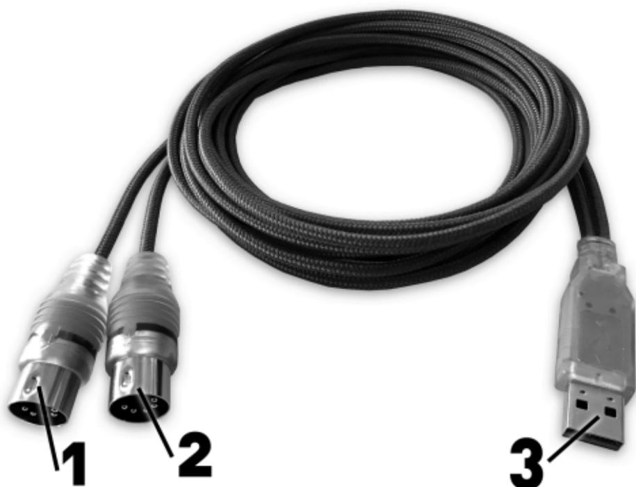
MIDIMATE eX bietet zwei separate MIDI-Anschlüsse (**1** und **2**) sowie einen USB-Anschluss (**3**). Die MIDI-Anschlüsse sind mit 1 und 2 markiert und können jeweils mit dem MIDI-Eingang (dann als MIDI Out) oder dem MIDI-Ausgang (dann als MIDI In) eines Geräts verbunden werden. Der USB-Anschluss geht an den USB-Port Ihres PC oder Mac.
